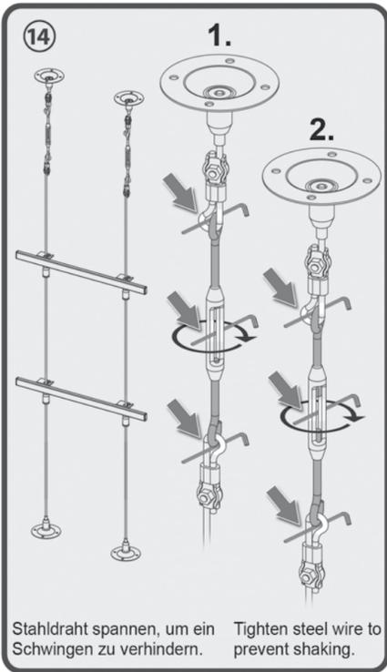
Stahlraht spannen, um ein Schwingen zu verhindern. Tighten steel wire to prevent shaking.
