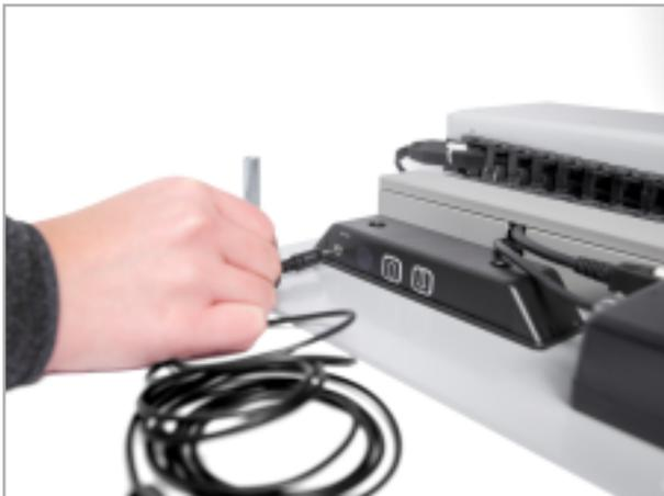
Abb. 7: Infrarot Verlängerung verbinden
