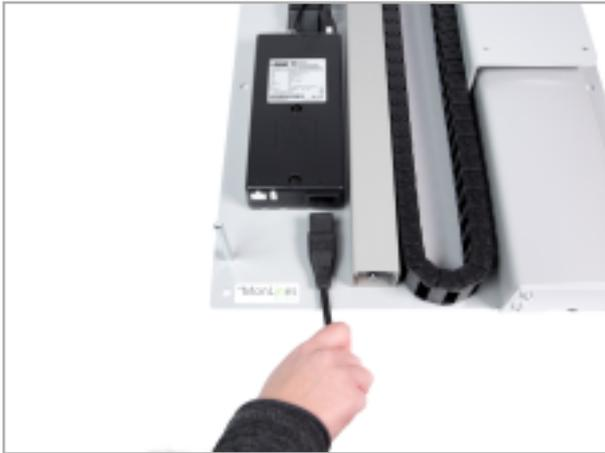
Abb. 6: Verkabeln der Steuereinheit
