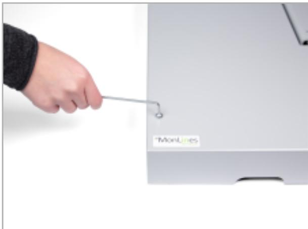
Abb. 3: Schrauben am Gehäuse lösen
