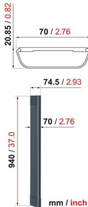
Die Kabelkanäle sind in 2 Breiten und 3 Farben erhältlich. Das Modell EFA 8740 ist für maximal 4 Kabel geeignet, EFA 8741 verbirgt bis zu 8 Kabel. Beide Modelle werden in weiß, schwarz und eloxiertem Aluminium geliefert. Die Montage ist einfach, eine Bohrschablone wird mitgeliefert.
