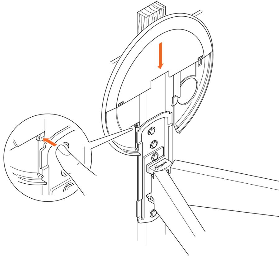
4. Schieben Sie die **obere Wandplattenabdeckung** (K) auf die **Wandhalterung** (A). Um die Abdeckplatte zu entfernen, drücken Sie auf die linke Lasche und schieben Sie sie von der Wandhalterung.
