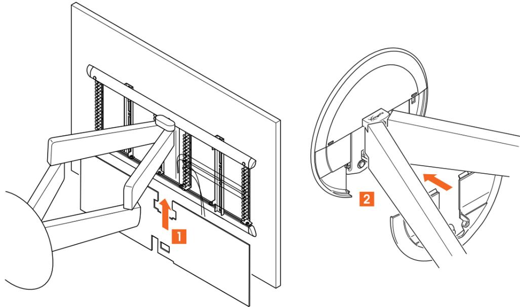
5. Setzen Sie die **untere Wandplattenabdeckung** ① auf die Wandhalterung und die **Adapterabdeckung** ② auf die Rückseite des **Adapters**.
