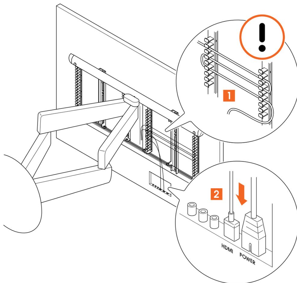
4. Schließen Sie das Netzkabel und die anderen Kabel am Fernseher an. Vergewissern Sie sich, dass alle anderen Kabel ordentlich verstaut sind, indem Sie die vertikalen Kabelklemmleisten am **Adapter** verwenden.
