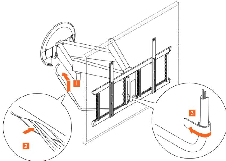
1. Befestigen Sie die **Kabelschutzhülle** (T) an der **Wandhalterung** (A), indem Sie sie in die Löcher an der Unterseite des rechten Arms schieben.
