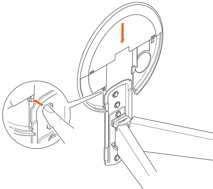
5. Schieben Sie die **obere Wandplattenabdeckung** ④ auf die **Wandhalterung** ①. Um die Abdeckplatte zu entfernen, drücken Sie auf die linke Lasche und schieben Sie sie von der Wandhalterung.
