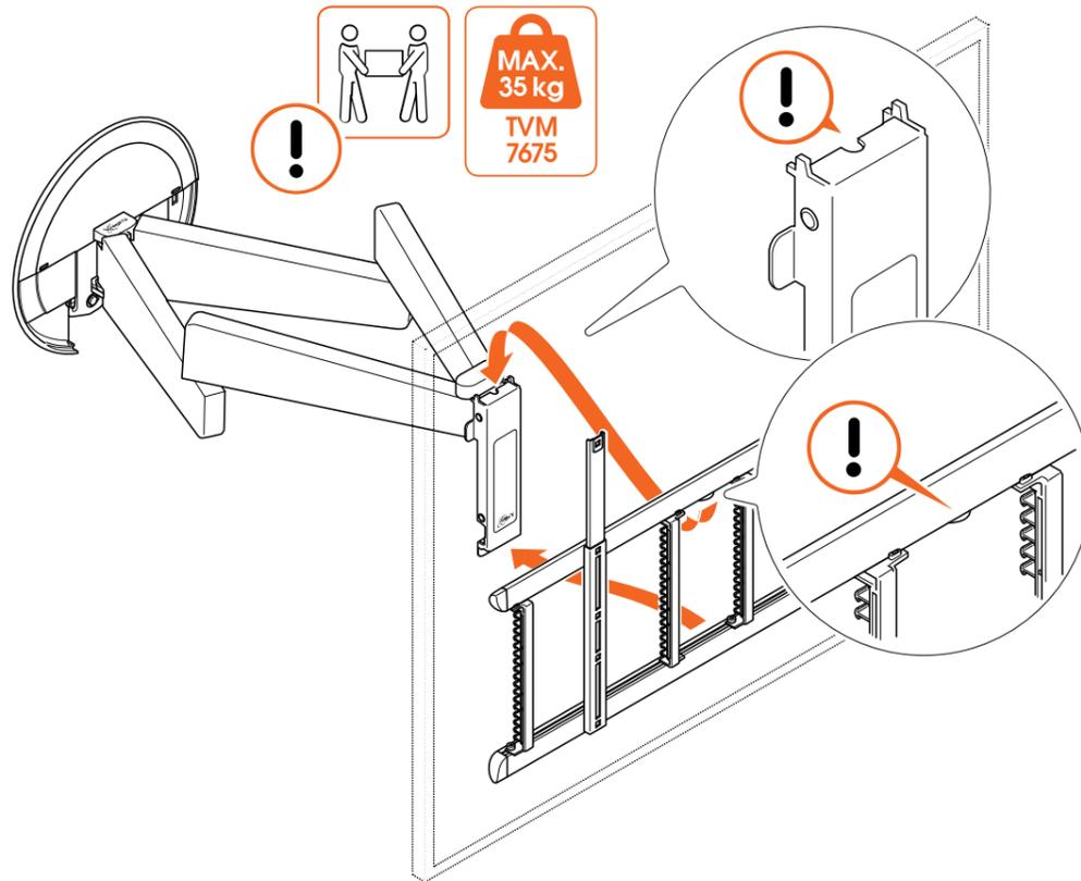
1. Heben Sie den Fernseher vorsichtig an und befestigen Sie ihn auf der Adapterhalterung an der **Wandhalterung** ①. Achten Sie darauf, dass der Stecker des Adapters in die Aussparung der Wandhalterung passt.
