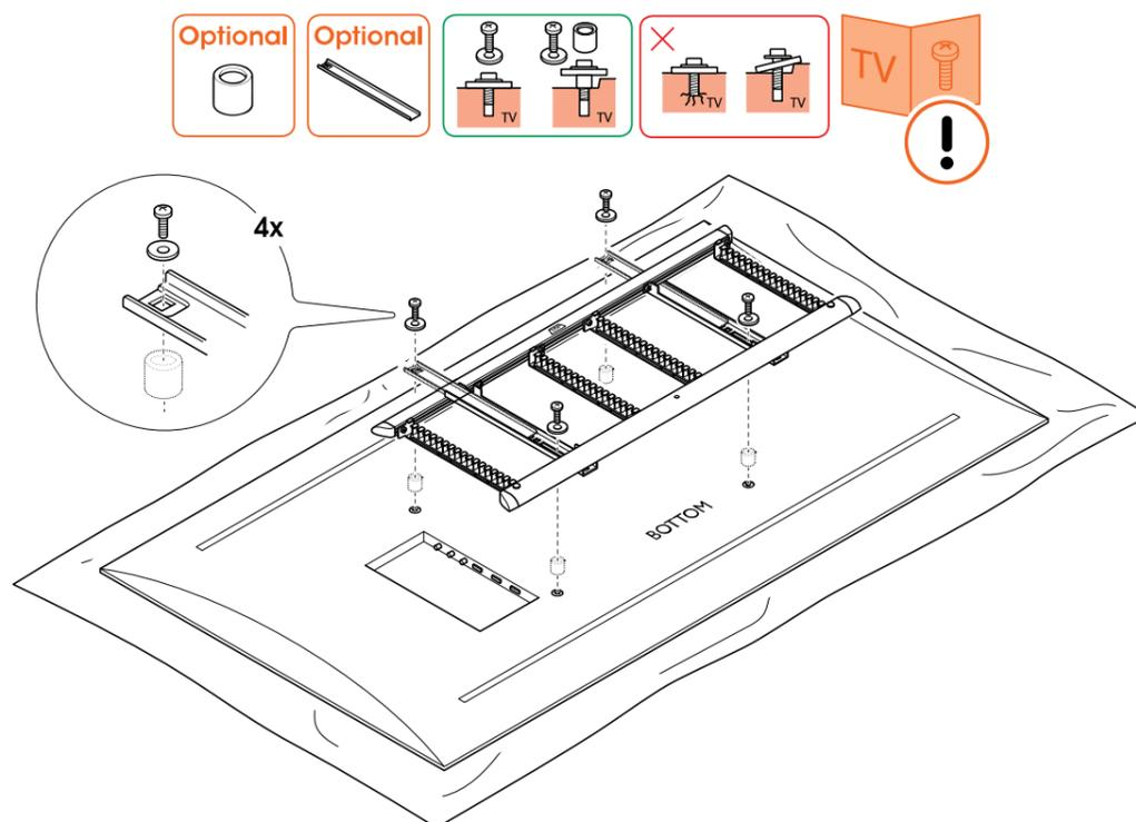
5. Schrauben Sie den **Adapter** mit den **Bolzen** ⑤ und **Abstandhaltern** ⑥ an den Fernseher. Vergewissern Sie sich, dass die Oberseite des Rahmens richtig positioniert ist, was durch das Wort „top“ auf dem **Adapter** angezeigt wird.
