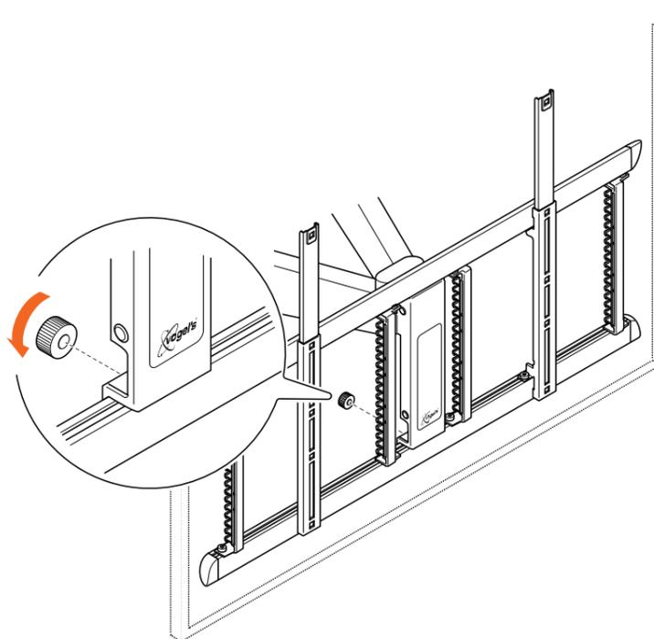
2. Befestigen Sie den Adapter mit der gesicherten **Flügelmutter** aus Schritt 1 an der **Wandhalterung**.
