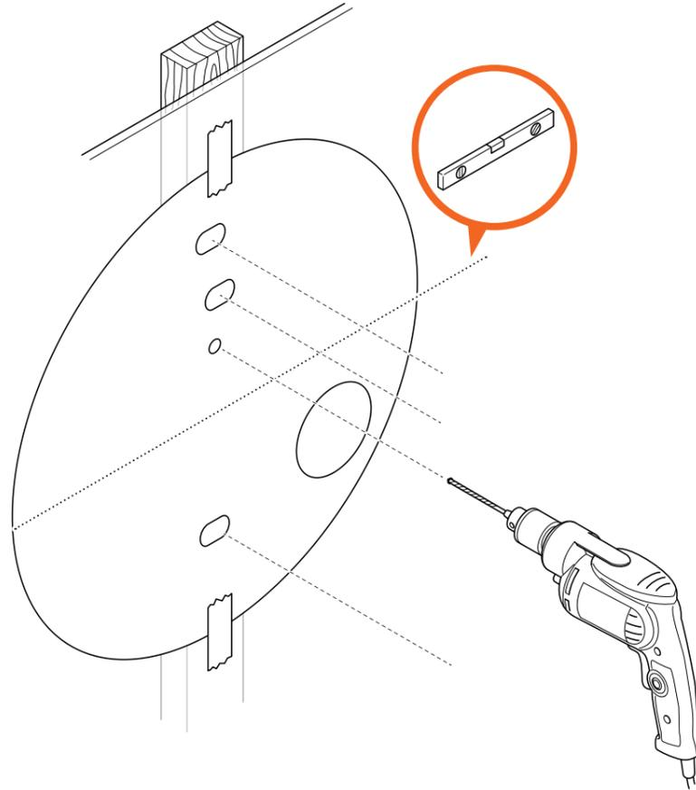
2. Jetzt kommt der spaßige Teil... Löcher bohren. Achten Sie darauf, dass Sie zuerst das Positionierungsloch bohren.
