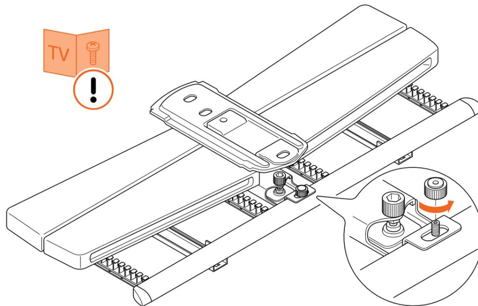
2. Entfernen Sie die **Flügelmutter** und nehmen Sie die **Wandhalterung** **A** vom **Adapter** ab. Bewahren Sie die **Flügelmutter** zur späteren Verwendung auf.
