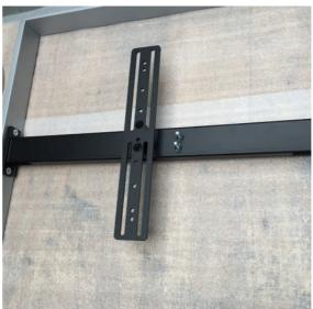
2) Den unteren Drehteller am Rahmen montieren (kurze M10 Senkschrauben)
